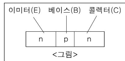
전자들은 양극으로 몰리고, B의 정공들은 음극으로 몰려 B-C 사이에 전류가 거의 흐르지 않는다. 이 상황에서 B에 양극, E에 음극을 연결하여 B-E 사이에 작은 크기의 순방향 전압을 걸어 준다. 이렇게 순전압이 걸리면 E의 전자들은 B에 접속된 양극으로 움직이고, B의 정공들은 E에 접속된 음극으로 움직여서 전류가 흐른다. 그런데 B의 폭이 좁기 때문에 E에서 B로 움직이던 전자들은 손쉽게 B를 지나 C로 건너간다. B-C 사이에는 이미 역전압이 걸려 있기 때문이다. 따라서 E-C 사이에 전자가 이동하게 되어 전자의 이동 방향과 반대 방향인 C에서 E로 전류가 흐르게 된다.
